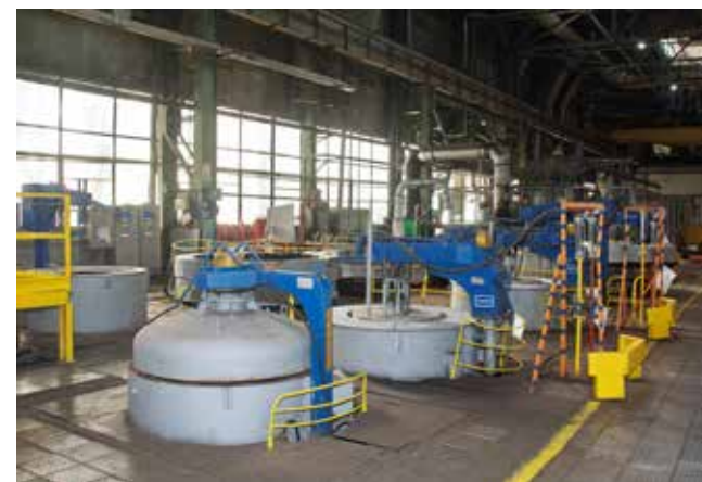
В печах производится закалка и цементация деталей
